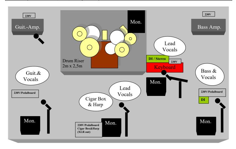
Der Veranstalter stellt eine Bühne von stabiler und solider Konstruktion, wenn möglich mindestens 6 Meter breit und 4 Meter tief. In Open-Air Situationen muss die Bühne stetig trocken bleiben!
